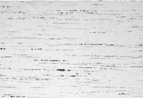
Oxidverteilung einer WT20 WIG-Elektrode
